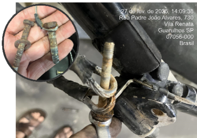
Detalhe parafusos conexão barra lateral / cabos dianteiro e traseiro e montantes
