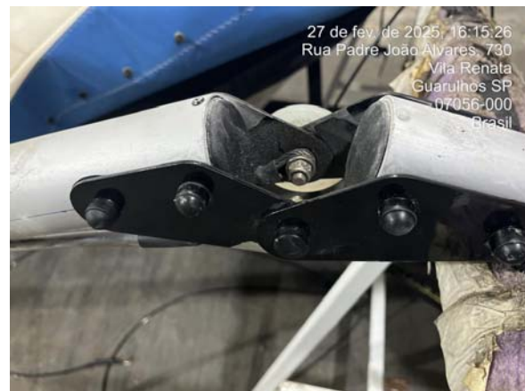
Conjunto do cross. Mesmo com a proteção do cross, nota-se vestígio de areia.
